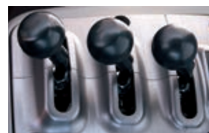
Control preciso Control de 3 palancas para el brazo de elevación, el cucharón y el tercer circuito. El interruptor FNR cambia la dirección de desplazamiento y los modos de reducción de marcha, volver a excavar, desconexión de la elevación del brazo y de flotación.
